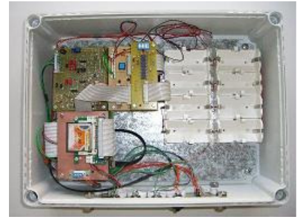
Abb.2: Blick in den Datenlogger GEOLORE
