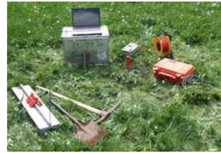
Abb.6.2: AMT-Basis mit den zum aufbauen benotigten Werkzeugen
